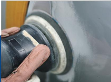
Schadstelle bis auf das blanke Blech, mit einem Schleifpapier der Körnung P120 vor- und der Körnung P180, nachschleifen (Excenter- oder Handschleifpapier). Danach Schadstelle vom Schleifstaub befreien. Geschliffene Schadstelle mit Standohyd Cleaner reinigen.
