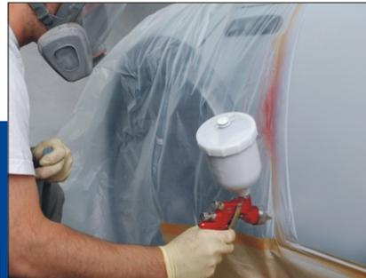
Stadox 2K HS-System-Füller 3 : 1 mit Stadox 2K-Härter MSX 15-30 mischen und einen dünnen Spritzgang auf die Schadstelle auftragen. Nachdem der Füller matt abgelüftet ist nochmals 2 Spritzgänge auf den Kotflügel auftragen. Stadox 2K-HS-System-Füller 3 Stunden bei 20° C trocknen lassen.
