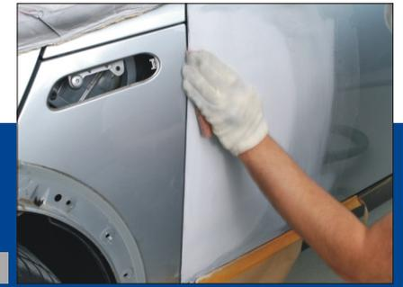
Den Füller trocken mit P400 Excenter- oder mit P600 - P800 Nass-Schleifpapier schleifen und anschließend die Fläche mit Standohyd Cleaner gründlich reinigen.
