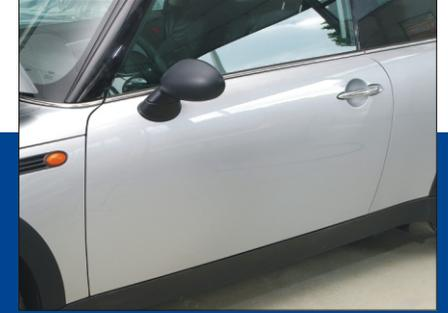
Nach dem Trocknen (20-35 Min./60° C Objekttemperatur oder über Nacht/20° C) können eventuelle Staubpartikel mit P1500 Schleifpapier, Schleifpolierpaste und Politur entfernt werden. Abdeckpapier entfernen, Anbauteile montieren.
