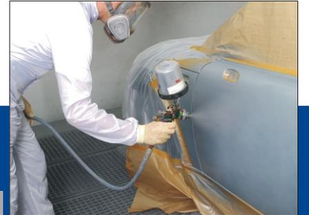
Standohyd Basecoat mit ca. 10% Standohyd VE-Wasser verdünnen und 1,5 Spritzgänge auftragen. Matt ablüften lassen. Standocryl VOC-Premium-Klarlack 2 : 1 mit 2K-HS-Härter mischen. Die Mischung ist spritzfertig. 1,5 Spritzgänge auftragen.
