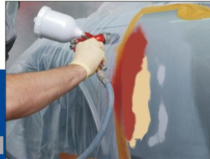
Blankes Blech mit Stadox 1K-Füllprimer vorgrundieren und 10 Min. trocknen lassen (ggf. leicht anschleifen / köpfen).
